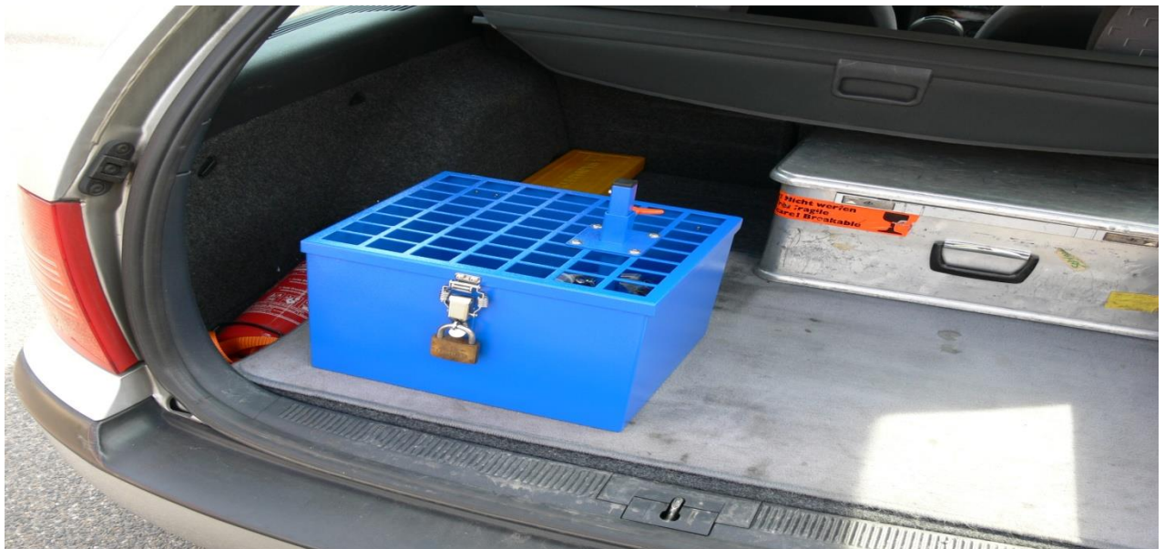
Bild 6 Zeigt die Transportbox auf der Ladefläche eines PKW-Kombi. Sie ist durch Schrauben im Boden der Box fest mit der Ladefläche verankert. Die Befestigung kann aber auch individuell z.B. durch Verwendung geeigneter Spanngurte erfolgen. Auf Wunsch können dazu an der Box entsprechende Ösen angeschweißt werden.
