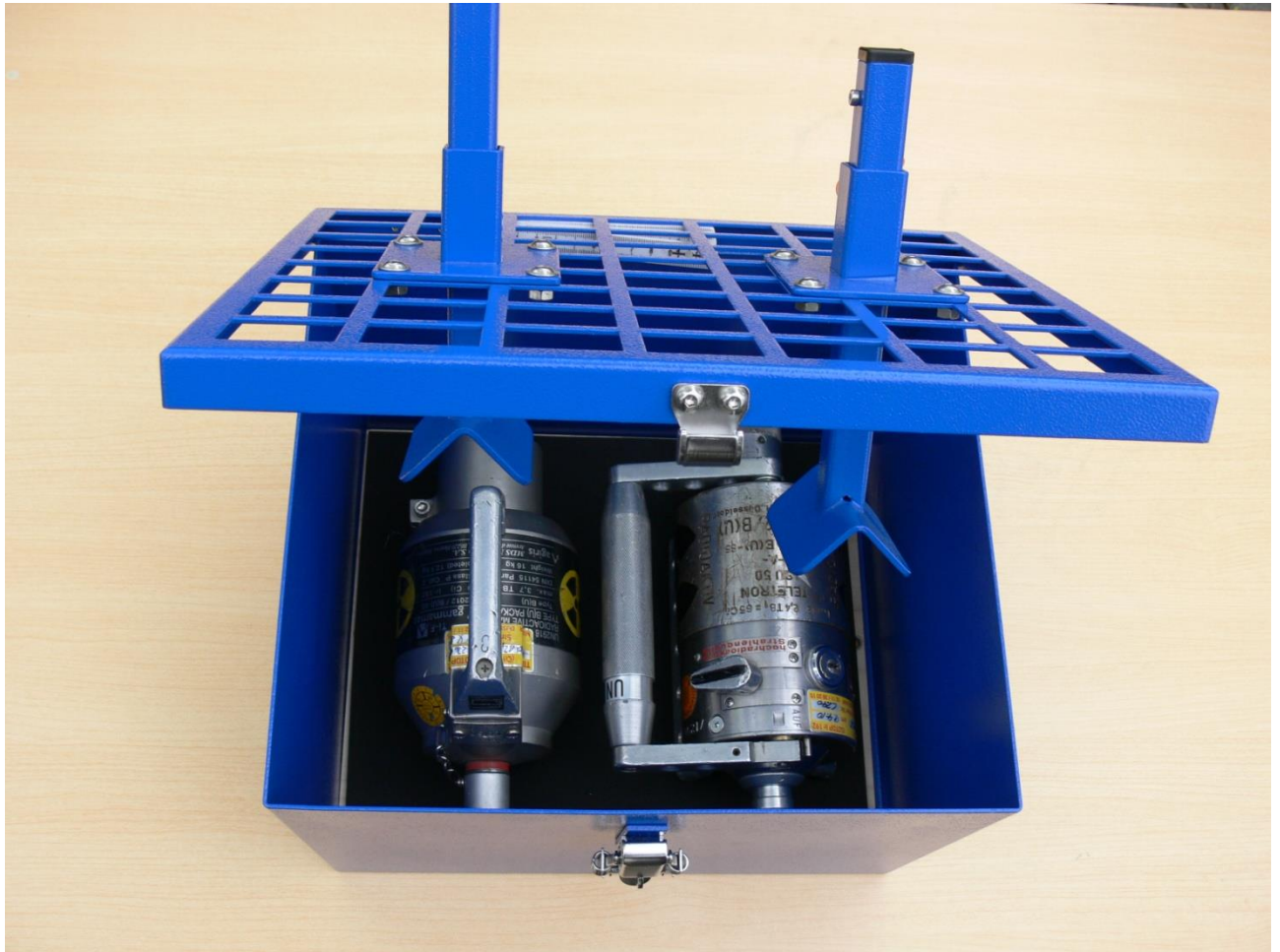
Bild 5 Gitterbox für die Beförderung von 2 Radiographie-Arbeitsgeräten in geöffnetem Zustand mit 2 Geräten
